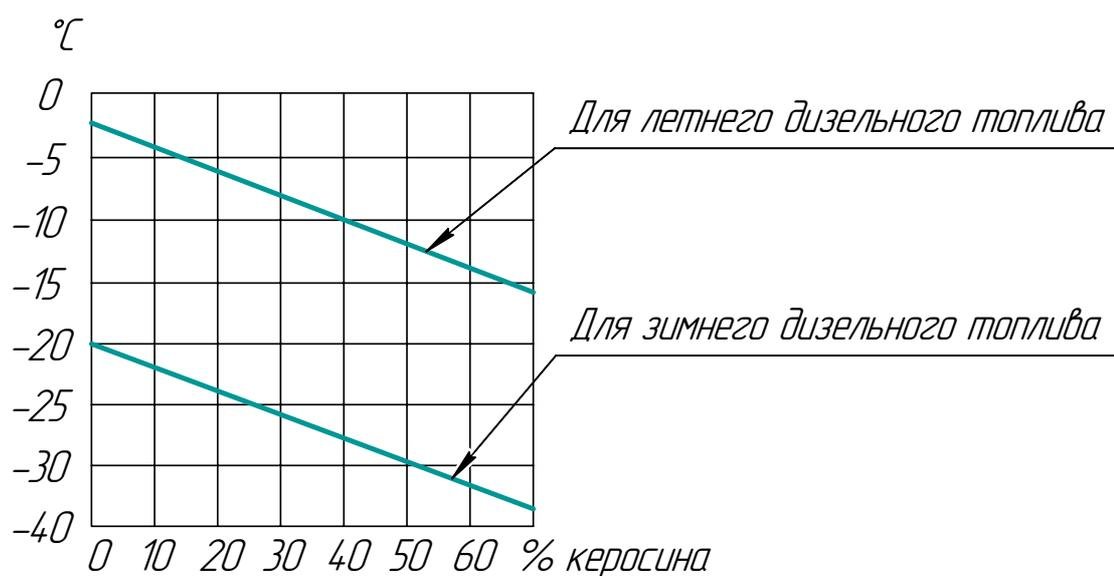
Рис. 10- Соотношение керосина с дизельным топливом в зависимости от температуры окружающего воздуха
